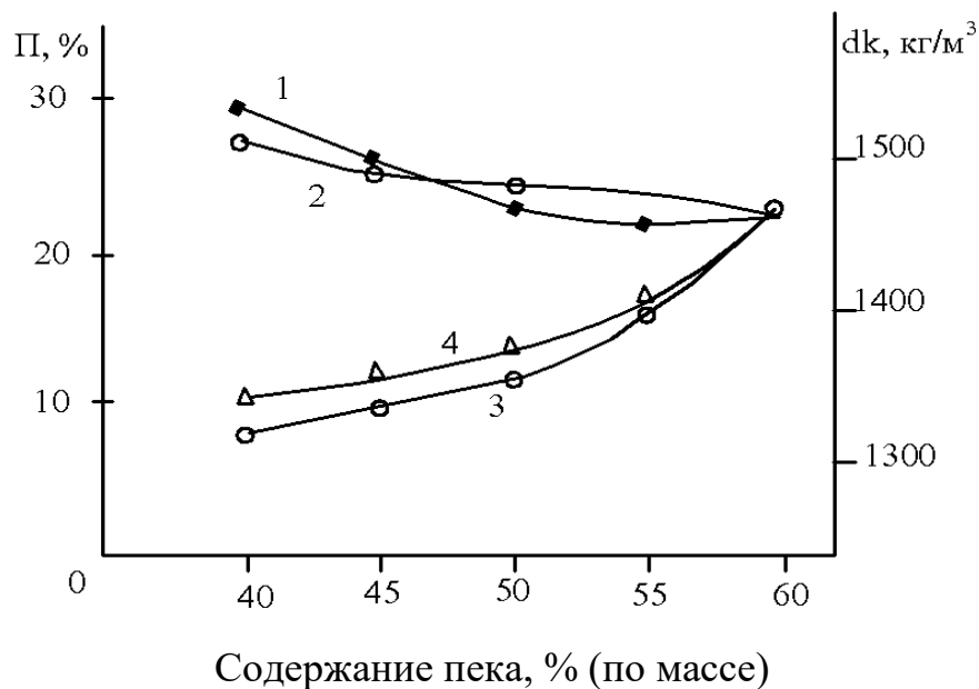
Рисунок 3.10 - Зависимость пористости ( П ) и кажущейся плотности ( d_k ) ХНПМ от содержания пека в связующем: 1- П (Назарайлок); 2 – П (Запорожье); 3- d_k (Запорожье); 4- d_k (Назарайлок)
