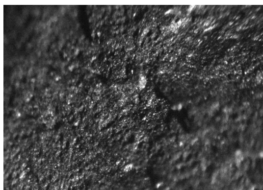
с. Микроструктура антрацита термообработанного при 1400^{\circ}\text{C} , \times 450
